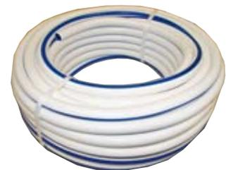
Tubo in PVC retinato flessibile atossico con doppio rinforzo tessile magliato (TRICOT) ad alta resistenza antitorsione. Resistente agli agenti atmosferici e a gran parte dei prodotti chimici. Temperatura d'impiego -10° +60° C. Pressione di esercizio 10 bar. Ideale per il lavaggio della barca o usi vari.
