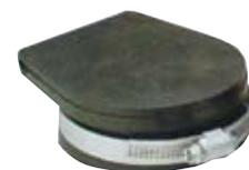
Antisifone in materiale plastico. Quando il punto di ingresso dell'acqua di raffreddamento nello scarico si trova ad un'altezza inferiore a cm 15 sopra la linea di galleggiamento, c'è pericolo che, spegnendo il motore, l'acqua di raffreddamento entri nel motore a causa dell'effetto sifone. Si posiziona almeno cm 40 sopra la linea di galleggiamento. Portagomma universale Ø mm. 13-19-25-32.
